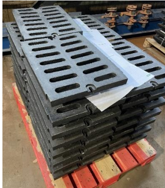
Wpusty ściekowe produkcja na rynek Czeski; klasa obciążenia B125
