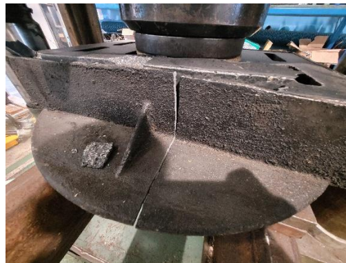
Uszkodzenie kołnierza żeliwnego (dla wpustów żeliwnych; punktowe podparcie) przy sile nacisku 249 kN
